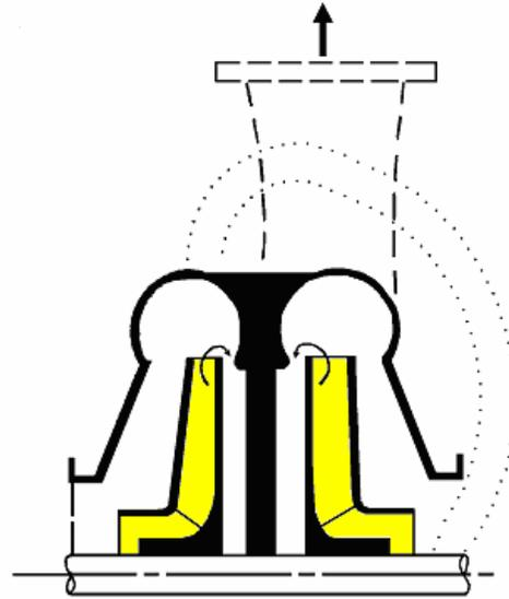
a.4. Two-Stage Back-to-Back Impeller Arrangement
