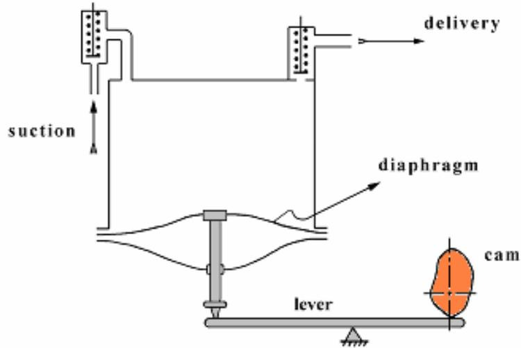
**Fig. 8.5 Diaphragm pump**
