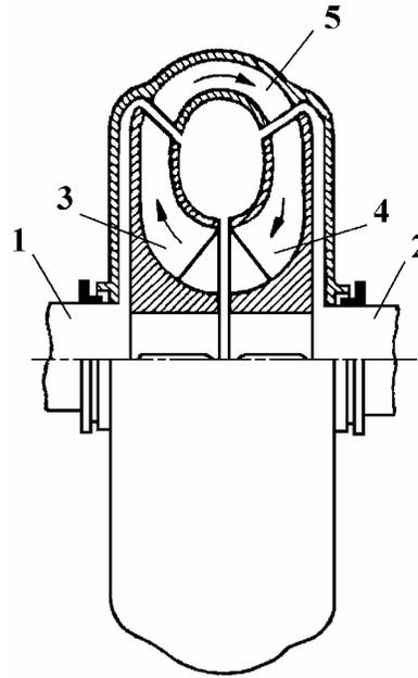
Fig. 5.37 Torque converter
