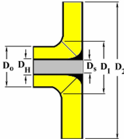
**Fig. 7.10 Impeller Dimensions**
