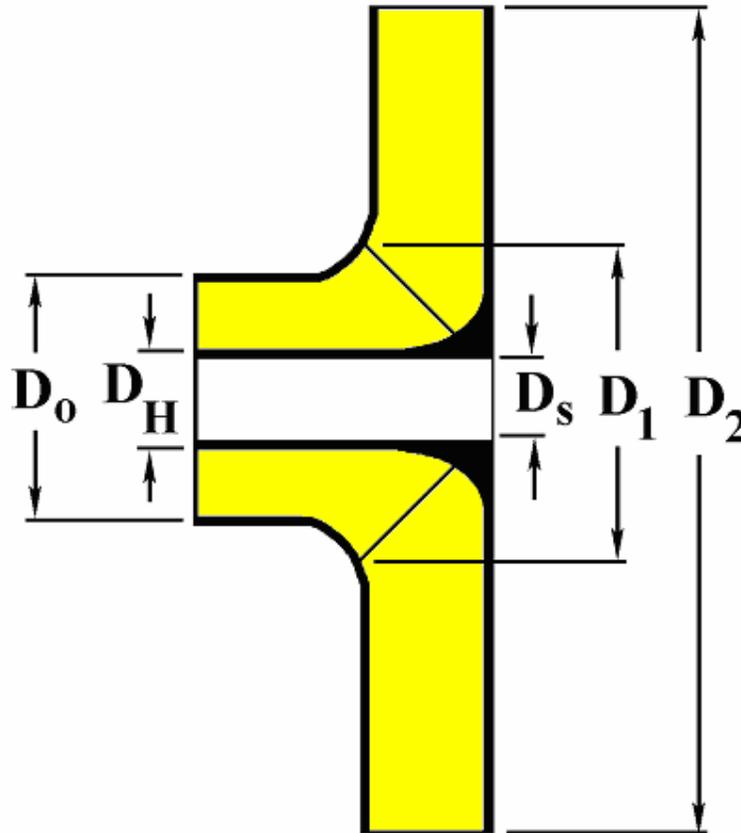
**Fig. 4.18 Impeller dimensions**
